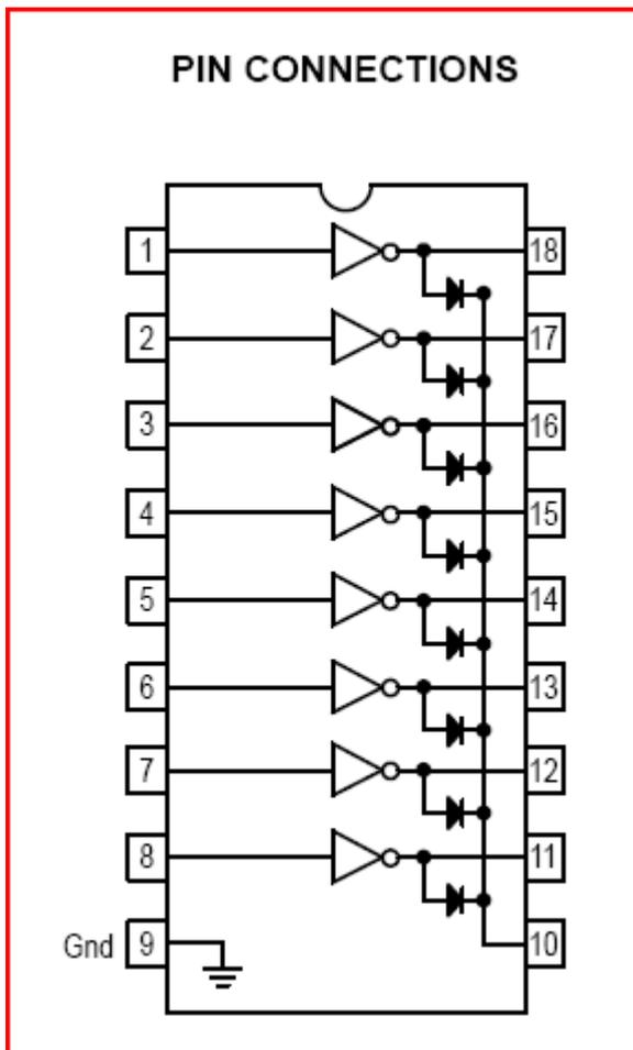
Somit schalten alle Ausgänge gegen Masse, d.h. ein zu schaltender Verbraucher wird mit einem Anschluss an seine benötigte Spannungsquelle angeschlossen und mit dem anderen Anschluss an das Modul. Der Chip schaltet dann den Verbraucher bei Bedarf an Masse.
