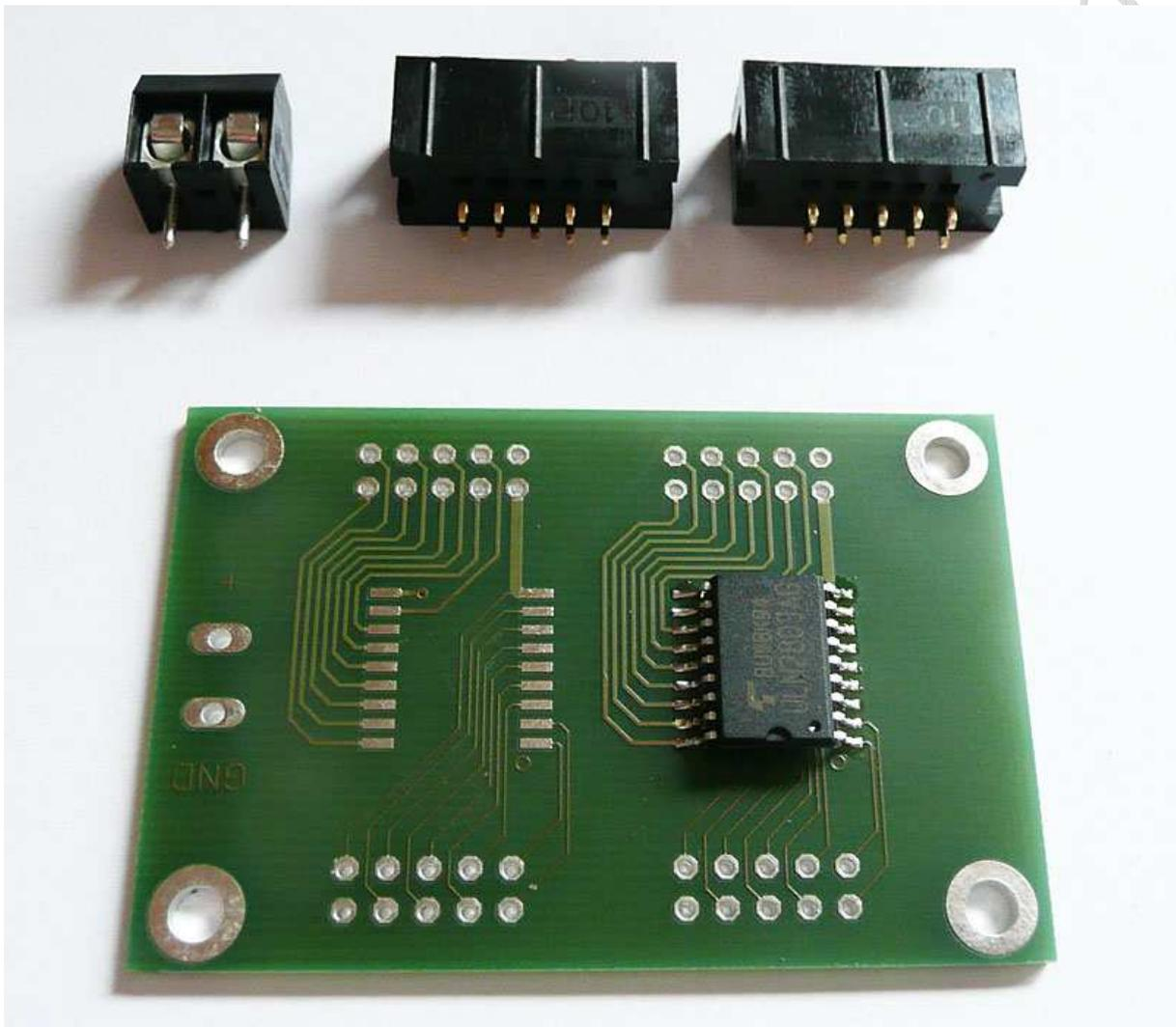
Das Foto zeigt die Platine für 8 Ausgangskanäle. Wenn Sie das Modul mit 16 Kanälen bestellt haben, so sind die oben gezeigten Stecker sowie die Chips doppelt vorhanden.
